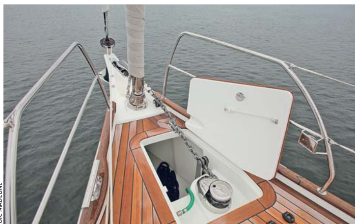
Etrave. Le bout-dehors est solidaire de la coque, taquets et balcons sont fixés sur le pavois, l'enrouleur électrique est invisible : la finition est irréprochable.
