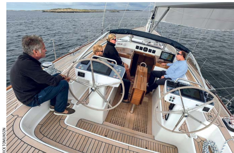
Postes de barre. A l'arrière du cockpit central, les postes de barre sont rehaussés afin d'offrir au barreur une visibilité idéale sur l'environnement du bateau.
